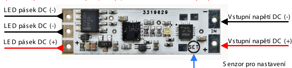
Obr.1 - Zapojení vývodů modulu stmívače
